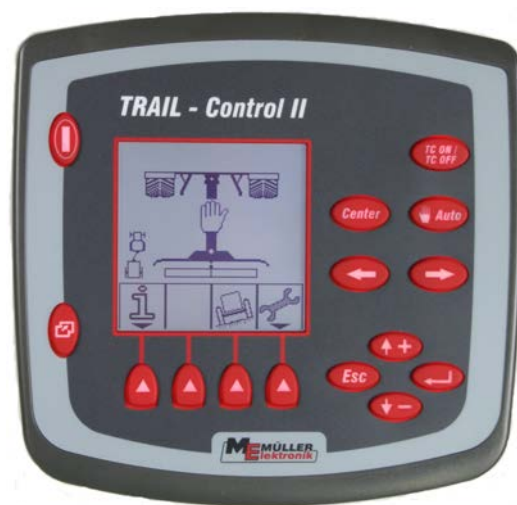
Bordrechner TRAIL-Control II - Vorderansicht
