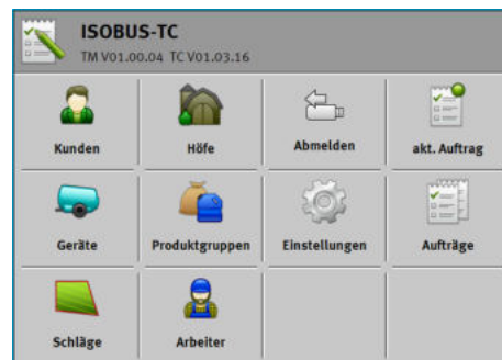
Konfiguration für die Arbeit mit ISO-XML-Aufträgen; Auf der SD-Karte befindet sich der Ordner Taskdata.
