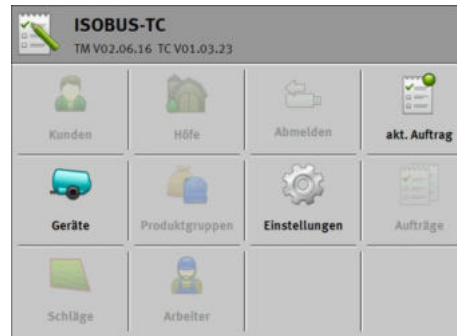
Configuration für die Arbeit ohne ISO-XML-Aufträge; Auf der SD-Karte gibt es den Ordner Taskdata nicht.
